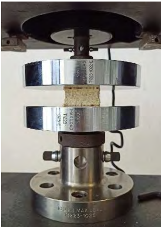
Figura 24: Prove a compressione
