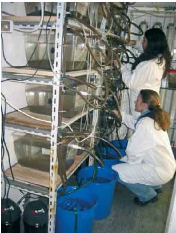
Fig. 2 - Sistema di allevamento a ciclo chiuso dell'esca rossa messo a punto per il programma presso il laboratorio di Ecologia del benthos della Stazione Zoologica di Napoli
