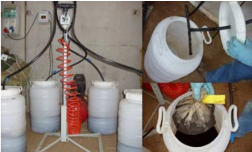
Figura 2. Dispositivo per la produzione di tea di compost areati.
