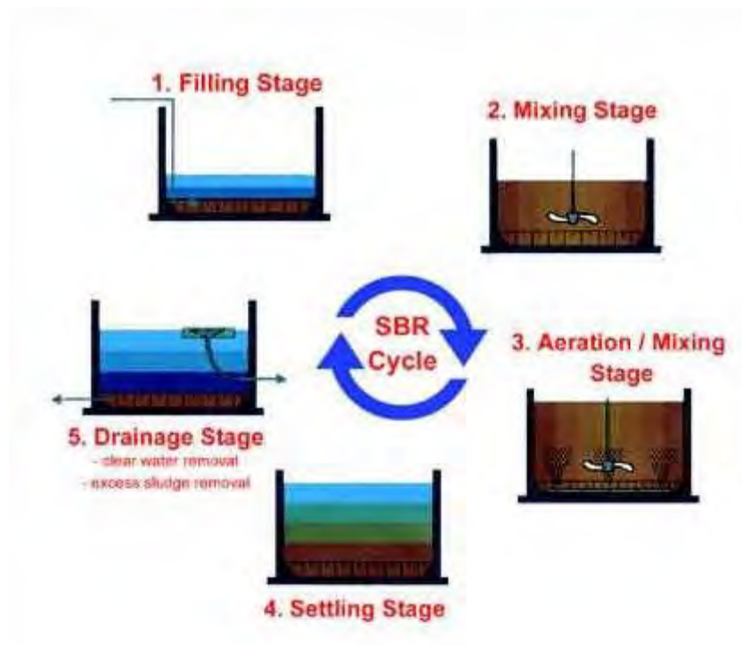
Figura 3.3. Rappresentazione schematica delle fasi di un processo SBR.
