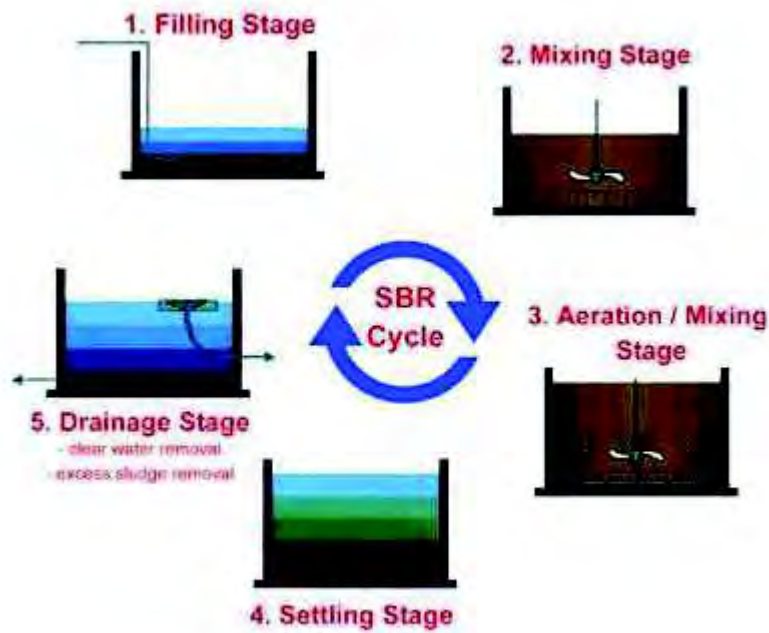
Figura 3.3. Rappresentazione schematica delle fasi di un processo SBR.
